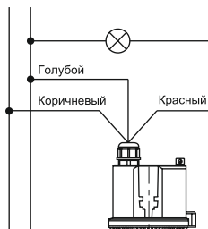
Рисунок 14 – Схема подключения датчика ДД-МВ601
